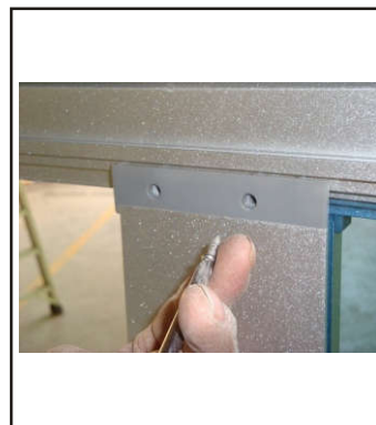
20. Fäst Aluminiumramen med M6x25 skruvar och muttrar
