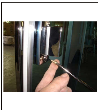
25. Montera magnetlisterna på glasdörrarna
